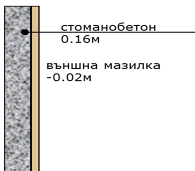
Фиг. 1.17. - състояние стени тип 5
